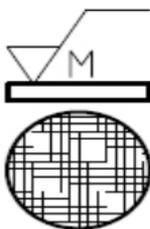
Die Rillenrichtung muß nach der Fertigung viele verschiedene Richtungen aufweisen.
